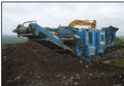
*Imagen: Planta móvil para RCD's*
