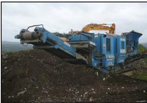
*Imagen: Planta móvil para RCD's*
